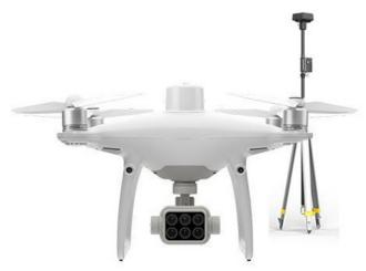
D-RTK 2 Mobile Station è il ricevitore GNSS di alta precisione aggiornato di DJI che supporta tutti i principali sistemi di navigazione satellitare globali, fornendo correzioni differenziali in tempo reale che generano dati di posizionamento a livello centimetrico per una maggiore precisione relativa.
