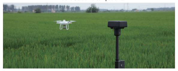
Migliora l'accuratezza del posizionamento RTK senza connessione a Internet collegando P4 Multispectral alla stazione mobile GNSS ad alta precisione D-RTK 2 e NTRIP (trasporto di rete di RTCM tramite protocollo Internet) o memorizza l'osservazione satellitare dati da utilizzare per Post Processed Kinematics (PPK).
