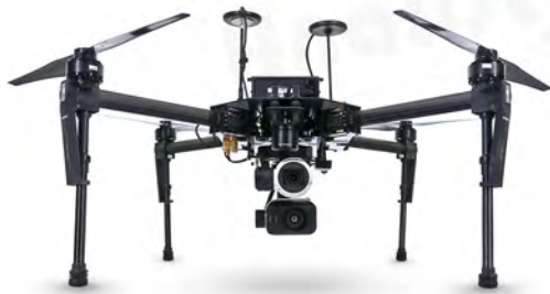
Velivolo utilizzato: INFRAPRO 100 equipaggiato con FLIR TAU 2 - by Analist Group
